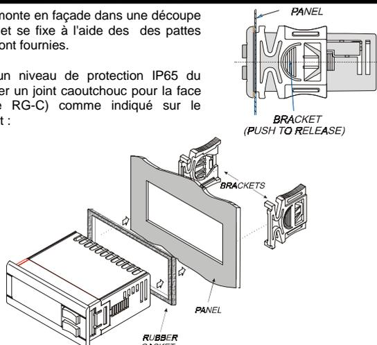
La gamme de température autorisée pour un fonctionnement correct de l'appareil est de 0 ÷ 60°C. Ne pas l'installer dans un endroit soumis à de fortes vibrations, à des gaz corrosifs, à des poussières ou une humidité excessives. Les mêmes recommandations s'appliquent aux sondes. Laisser l'air circuler autour des fentes d'aération.
