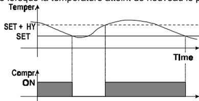
En cas de défaut de sonde, le démarrage et l'arrêt du compresseur sont programmés par les paramètres "COH" et "COF".
