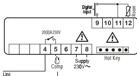
**Alimentation 12Vca/cc** : se connecter aux bornes 7 et 8.
